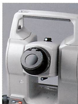
太陽フィルター OF3A フィルターはね上げ式
